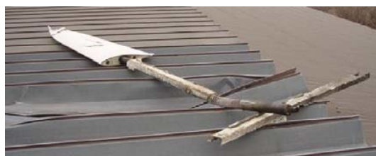
(d) 落雷により周囲に飛散したブレード(No. 11)
