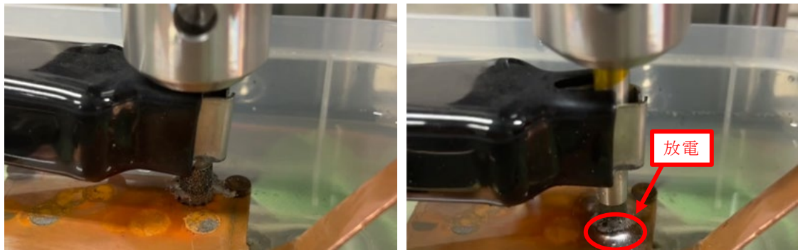
(a) SD100 電着砥石による放電実験の様子
