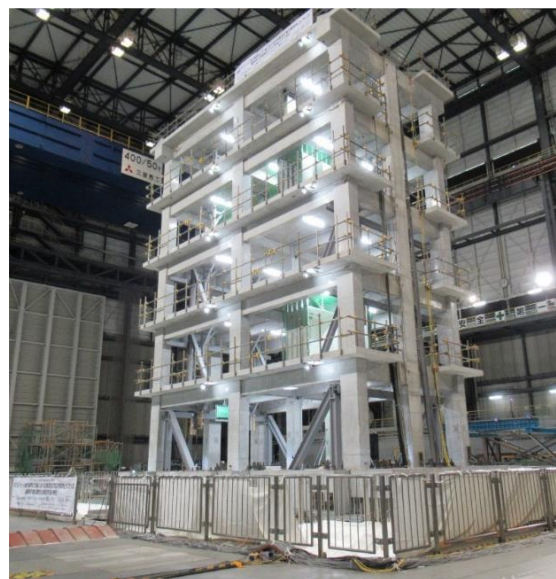
写真 1 5階建て RC 造建物振動実験試験体全景
