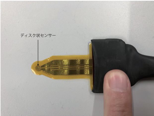
図3 ディスク状センサーの様子。この写真はセンサー直径Φ4のもの。実際に利用したのはセンサー直径Φ7のもの。
