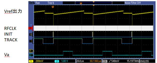
図19 Vrefトラッキング回路の動作検証
