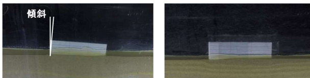
写真3 振動終了後の住宅模型の状況 (左: Case1 右: Case2)
