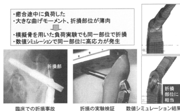
図11 ヒップスクリューの折損原因究明のための実験と解析例
