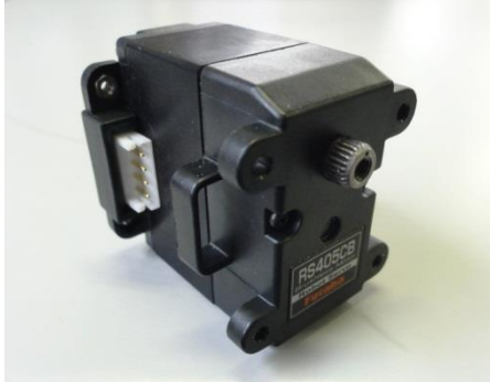
図4 アームモジュールの関節に使用したシリアルサーボモータ
