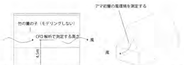
図5 広域的な分析における、No.28の家屋のモデリング。断面図(左)、アイソメトリック図(右)
