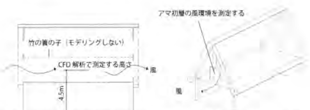
図6 局所的な分析における、No.28の家屋のモデリング。断面図(左)、アイソメトリック図(右)
