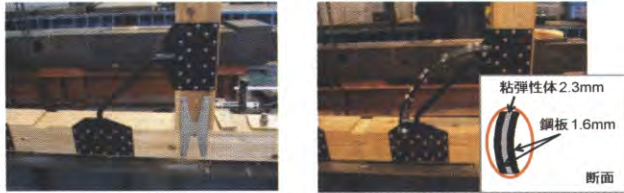
仕口耐震装置 図1 真壁用仕口設置型耐震装置
