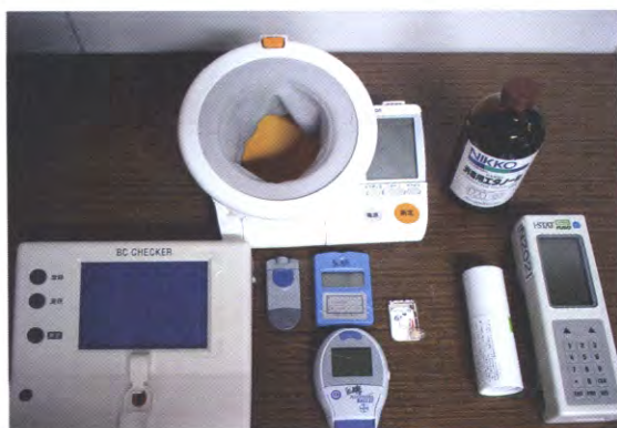
図2 測定器具（左より BCチェッカー、血圧計、穿刺器具、乳酸値測定器、血糖値測定器、イオン化量センサー、微量採血管、イオン化量測定器）
