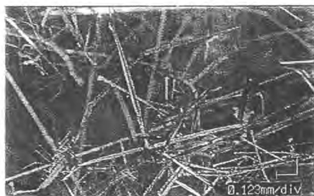
図 4 焼成後の水酸化カルシウム添加率 25%
