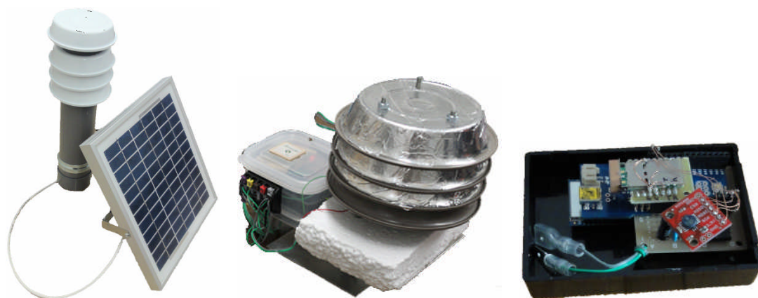
Figure.2 左：ベースステーション/リレーステーション（気象・大気・振動観測） 中：エンドステーション（大気・気象観測） 右：小型エンドステーション（大気・気象観測）
