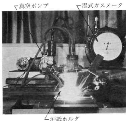
写真2 溶紙ホルダを用いた溶接ヒューム捕集装置
