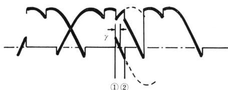
第8図 誘導電動機負荷のノッキング誤動作出力波形
