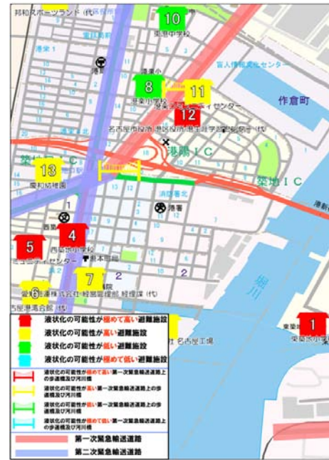
図 4 想定東海地震時の液状化危険度
