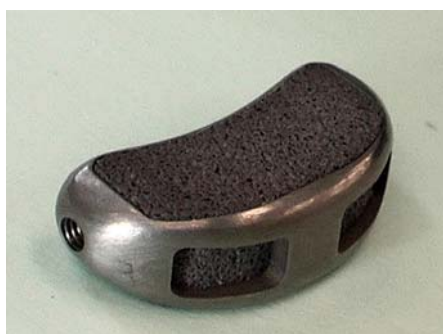
図9 チタン多孔材／緻密材複合椎間スパーサー試作品の外観
