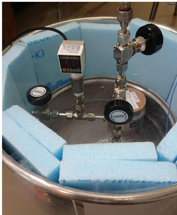
Fig.12 液体窒素での加圧容器の冷却状況
