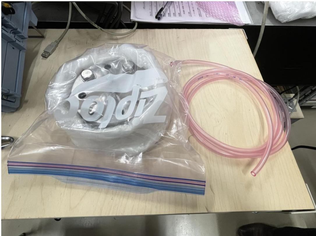
Fig.16 ジップロックで作ったガス回収バックに収められた断熱材にくるまれた圧力容器
