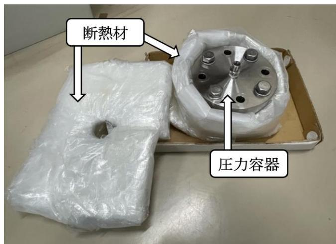
Fig.13 断熱材で包まれた圧力容器
