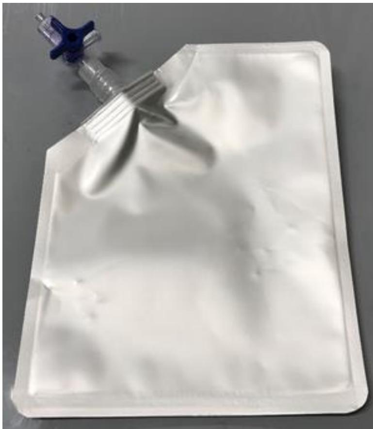
アルミパウチに三方活栓を接続した容量 400mL の呼気採取バッグ（呼気生化学栄養代謝研究所）.
