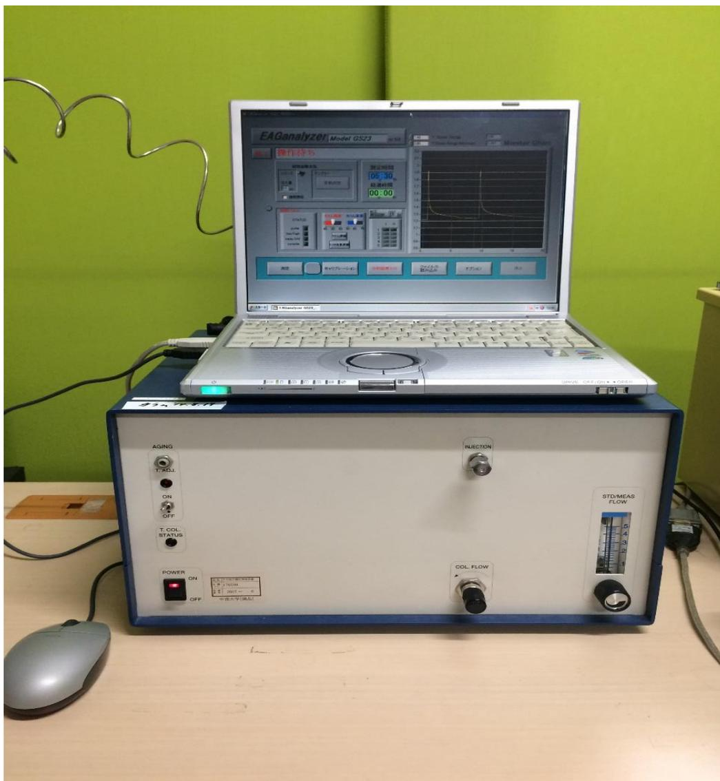
ガスクロマトグラフ半導体センサを原理としたガス分析装置（TRILyzer mBA-300, 株式会社タイヨウ社）。
