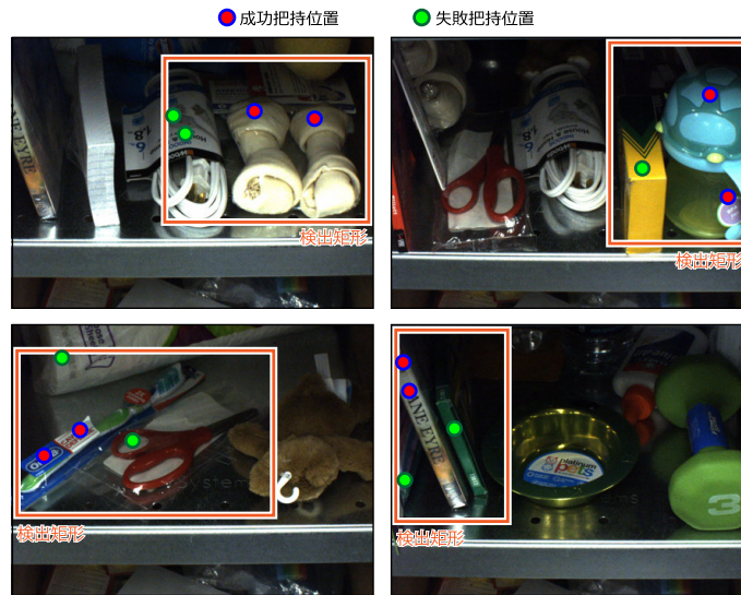
図 7.10: Faster R-CNN により検出された物体矩形内の把持位置検出の例。
