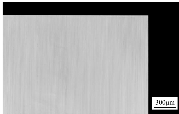
図 5.42 研削した試料コーナ部の走査型レーザ共焦点顕微鏡像
