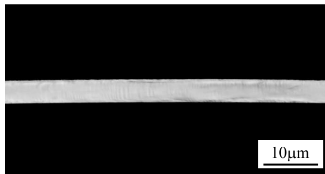
図 5.45 研削した PMN-PT 単結晶{001}面の断面の走査型レーザ共焦点顕微鏡像
