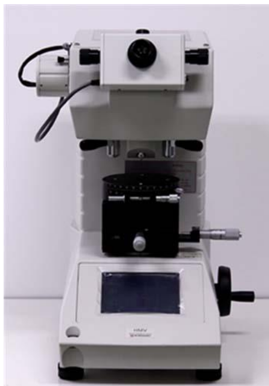
図 3.2 微小硬さ計の外観写真
