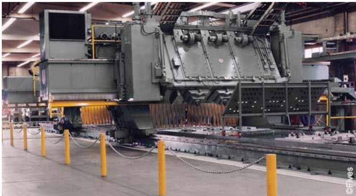
図 1.9 大型多頭 5 軸機の例 (シンシナチ 3 頭 5 軸プロファイラ)
