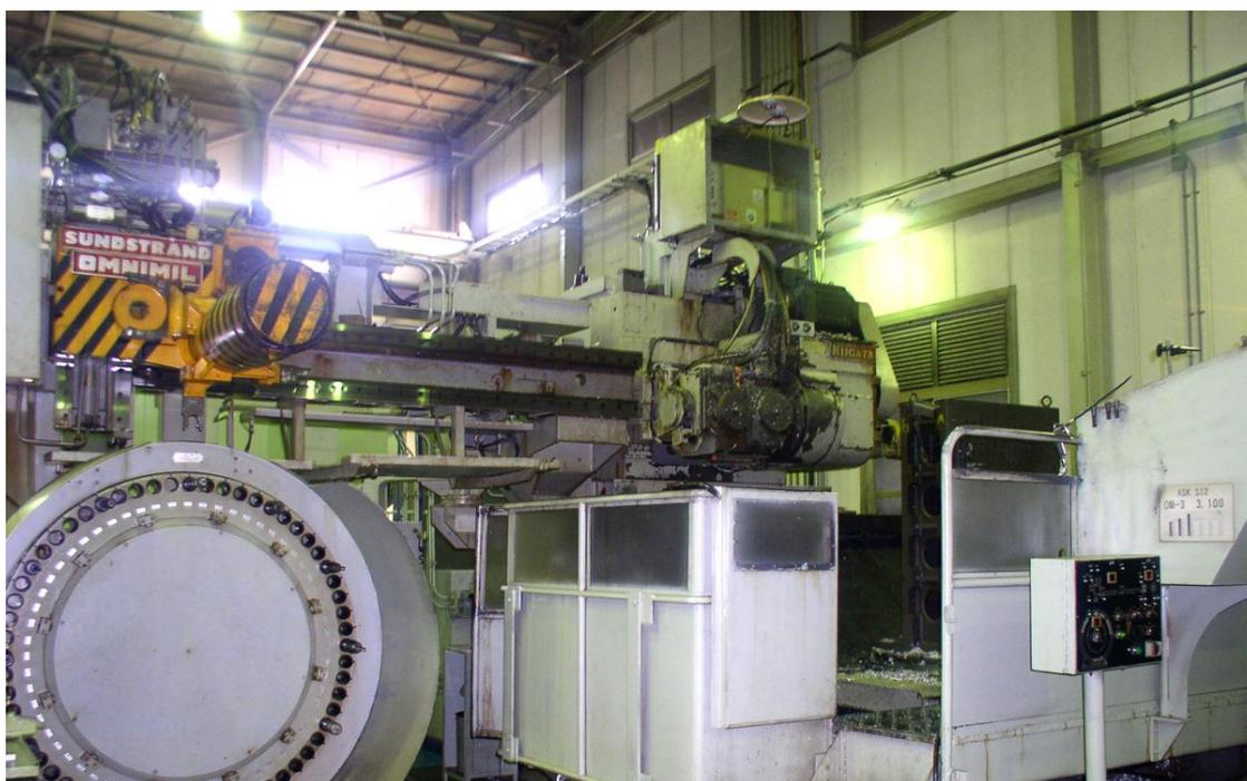
図 1.3 アイコクアルファ(株)で 1975 年に初めて導入した同時 5 軸マシニングセンタ
