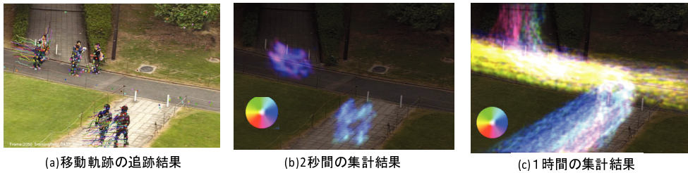
図 2.8: 特徴点の移動軌跡の追跡結果と集計結果の例 (文献 [27] から引用).
