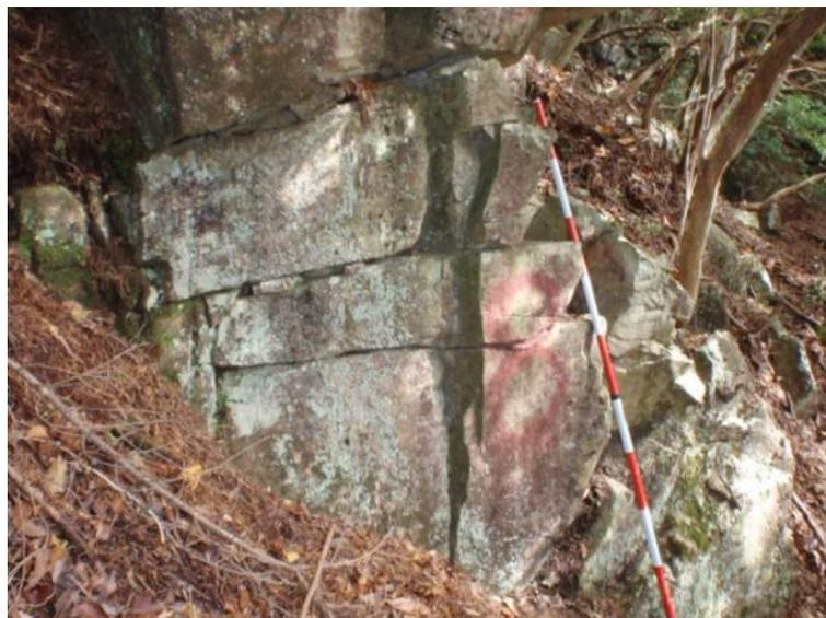
写真 2-4. 落石発生源となる小規模岩盤露頭
