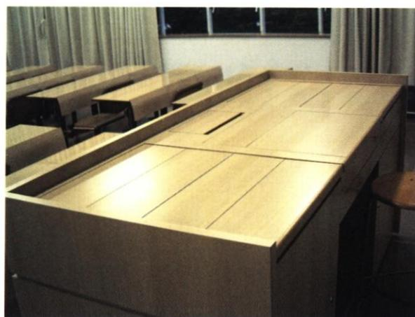
なお、マイクロフォンのみで使用する場合には、電磁ロックを解放する必要はない。操作卓中央の上部にあるカバーを開き、接続ジャックにマイクロフォン端子を差し込むだけでよい。また、ワイヤレスマイクでの利用も可能である。
